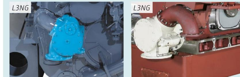
**Direkt angeflanschte Schmierölpumpe**
