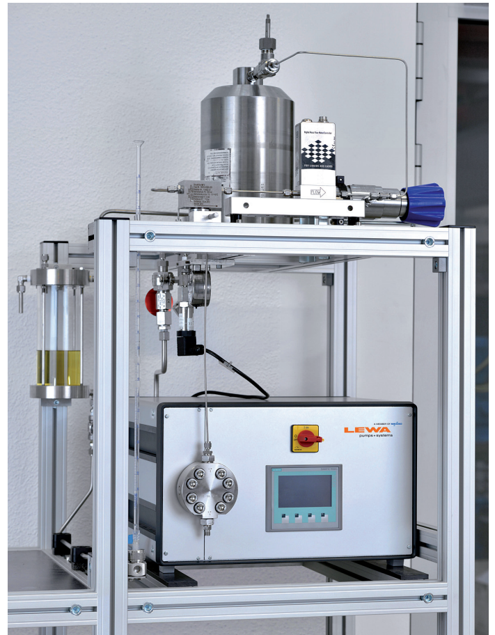
Abb. 2: Die Hochdruck-Mikrodosierpumpe kann unter realistischen Bedingungen deutlich präzisere Ergebnisse liefern, als das bei Kolbenpumpen möglich wäre und wird daher unter anderem für die exakte und reproduzierbare Dosierung in den Prozessen Hochdruck-Synthese und Hochdruck-Hydrierung eingesetzt werden.
