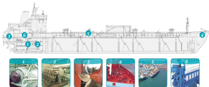
Abb. 1: Darstellung verschiedener Anwendungsbereiche der Leistriz Schraubenspindelpumpen L2, L3, L4 und L5 im Schiffbau: Schmierölsystem für Maschinenräume (1), Heizölssystem für Maschinenräume (2), Ruderanlagen und Verstellpropeller (3), Winden (4), Be- und Entladen (5), Sonderanwendungen (6)
