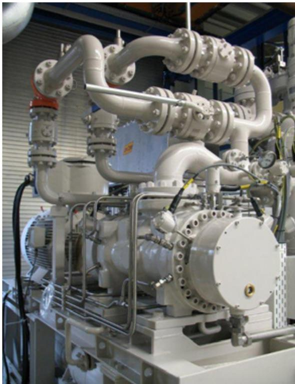
**Bild 5:** Multiphasenpumpen-Aggregat auf Multiphasenpumpen-Prüfstand
